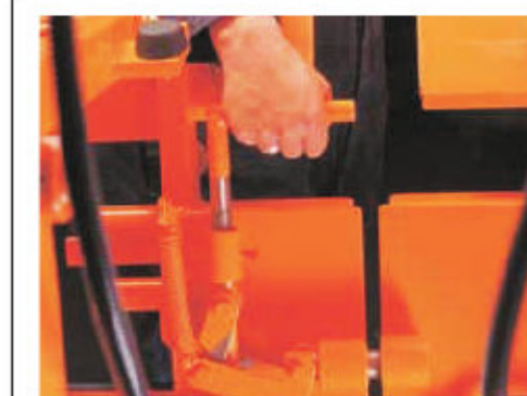
Jednoduchou operací se spojí a uzamknou oddělená hřebenová zavěšení, takže mohou pracovat společně (jako nedělený vyklápěč)
